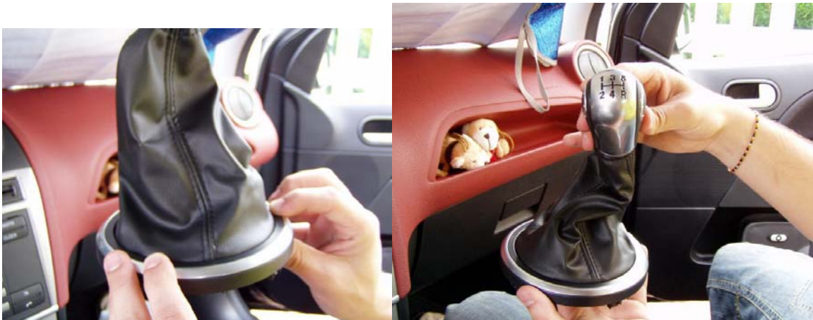
5. Se introduce componenta originala FORD pe inelul de la baza burdufului. Se repeta pasii anteriori in sens invers.
